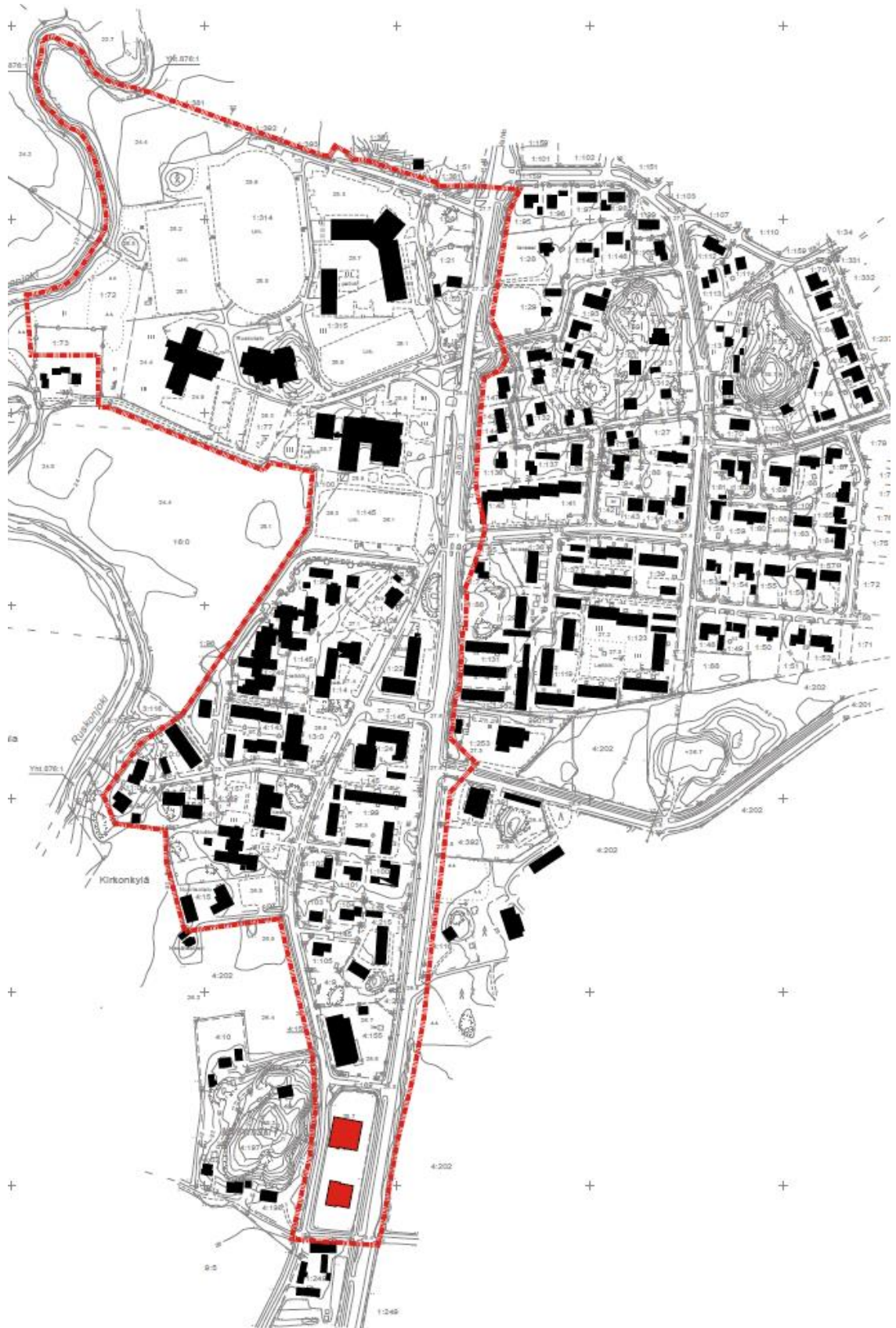
Kuva 30. Rakeisuuskartta. Mustalla on osoitettu olemassa olevat rakennukset ja punaisella asemakaavan muutoksella ja laajennuksella osoitetut rakennukset.
